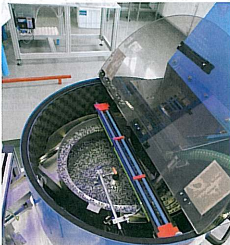
Die Teile werden aus dem Schüttgut mit einem Vibrationsfördertopf vereinzelt
