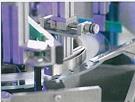
Ein Glasteller führt die Prüfteile den Kamerastationen zu
