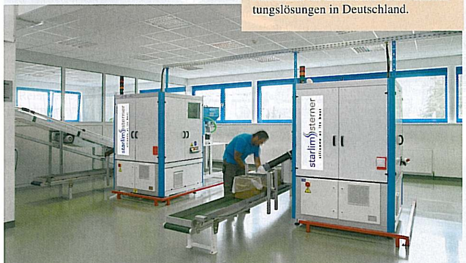
Die Mehrmaschinenbedienung wird durch integrierte Verpackungsbänder und Zuführeinheiten sicher gestellt. Das System kann mehrere Stunden ohne Bedieneringriff laufen. (Bilder ohne Angabe: Christoph Goldmann)
