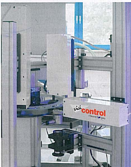
An einer Kamerastation werden mit 2 telezentrischen optischen Systemen die Maße hochaufgelöst bestimmt und präzise mit Toleranzen verglichen
