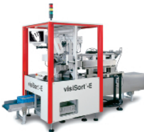
Weltrekordler: Mit der visiSort-E lassen sich über zwanzig Merkmale einer Schraube buchstäblich im Flug überprüfen. Durchsatz: bis zu 1.200 Schrauben/min.
